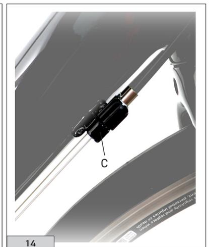
• Schneiden Sie die Hülle (auf der Rahmenseite) bis zum metallischen Kabelstopper ab, der bereits am Rahmen angebracht ist (C - Abb. 14).
