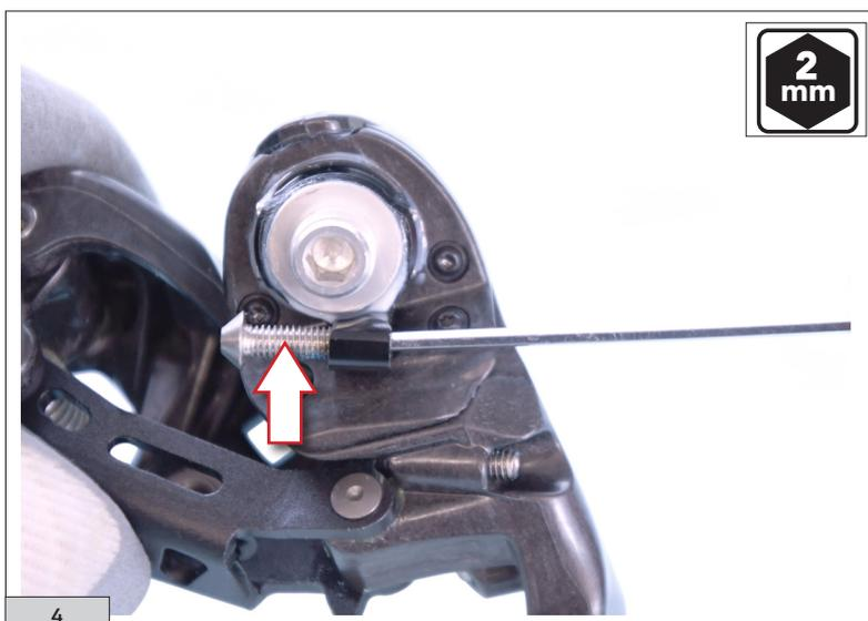
• Bringen Sie, unter Verwendung eines 2 mm Inbusschlüssels, die Schraube zum Positionieren des Schaltwerks mit Gelenk an (Abb. 5).
