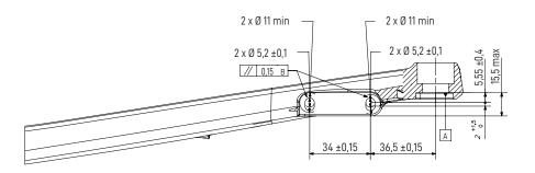
BRAKE CALIPER FIXING BOLT CON-TACT FACE IS Ø 11 BRAKE CALIPER FIXING BOLT TIGHTENING TORQUE IS 6-8 Nm
